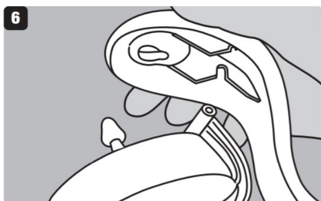
6 joondage käepideme soon varrega ja vajutage käepidet õrnalt alla. Lükake, kuni kuulete klõpsatust.*
